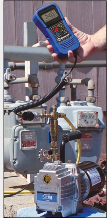
**98061** Vacuomètre numérique emballé dans un boîtier moulé
