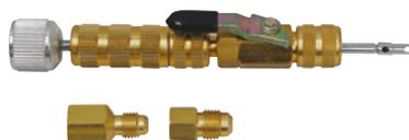
Nouveau design à mécanisme de blocage patenté. Le kit 91498 est le seul outil démonte/remonte noyau de vanne incorporant un écrou de sécurité. Celui-ci permet le technicien d'engager le noyau de vanne sans devoir combattre la Haute Pression. Ce kit comprend le filetage 1/2"-20 UNF (japonais) ainsi qu'un raccord 1/4" SAE. Emballé en boîte en plastique rigide.
