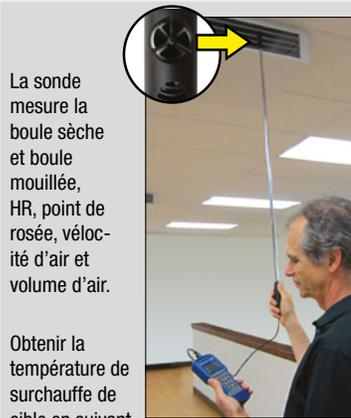
La sonde mesure la boule sèche et boule mouillée, HR, point de rosée, vélocité d'air et volume d'air.
