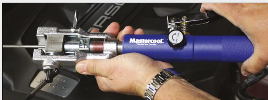
Ce kit évase en dimensions de: 1/4, 5/16 et 3/8"; Evasement de tube conduite de Fuel sur GM, en 5/16 et 3/8"; Evaseur / double évaseur, 3/16, 1/4, 5/16, 3/8 et 1/2" Evaseur - bulle métrique, 4,75, 6, 8 et 10 mm présentation dans une boîte moulée spéciale en plastique. **No. de Brevet 5,782,128**
