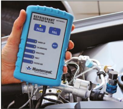
Maintient la sécurité de l'équipement, Empêche la contamination, Détecte la contamination par l'air.
