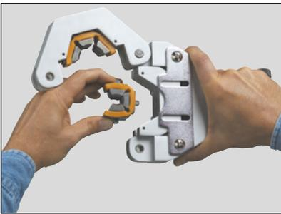
La matrice se place aisément et rapidement dans la presse sans demander ni vis, ni autres moyens de fixation.
