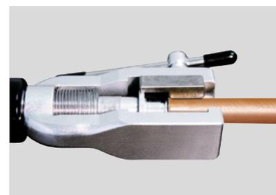
Le tube cuivre est tenu dans l'étrier par les matrices. La presse hydraulique pousse la matrice pour exécuter l'évasement ou l'expansion. Photo: la procédure en cours
