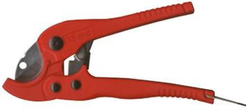
Le système à cliquet de ce coupe-tube rend l'outil facile à opérer, dont le résultat se solde par des coupes fines et nettes. La lame de coupe est faite d'acier trempé spécial, qui permet une longue vie à cet outil. Coupe tous les tuyaux en caoutchouc et PVC jusqu'à 1/2" O.D. (pas recommandé pour PVC200)
