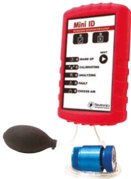
Le 691234YF-MINI permet de vérifier la présence et la qualité du fluide frigorigène R1234yf dans les systèmes de climatisation des véhicules, afin d'éviter tout risque de contamination du fluide frigorigène. Le MINI ID permet une analyse rapide et précise du fluide frigorigène dans un boîtier autonome, compact et extrêmement portable. Il fournit automatiquement une indication étape par étape du processus d'échantillonnage de gaz.
