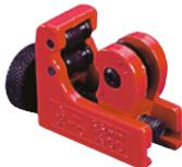
Appareil pratique à l'utilisation aux endroits offrant peu d'espace de travail. Coupe le cuivre doux, l'aluminium et tubes à paroi fine. Coupe-tube pour tubes de diamètre extérieur de 1/8 à 7/8" (4 - 22 mm).
