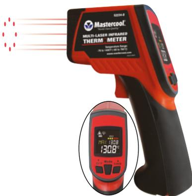
Le thermomètre infrarouge multi-laser surveille en toute sécurité matériaux chaudes, dangereux ou difficiles à atteindre, sans contamination ou endommagement de la surface. Il suffit de pointer sur la cible, tirer le gâchette, et lire la température.
