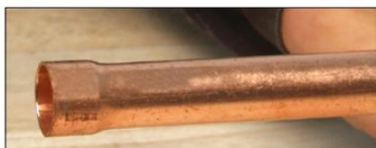
Forme, élargit un tube en cuivre, aluminium ou acier doux par pression hydraulique avec le but d'y emboîter d'autres tubes.
